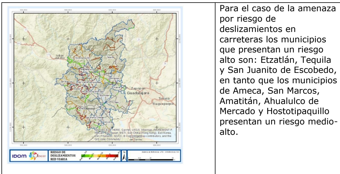
Figura 31. Riesgo de deslizamientos en carreteras
