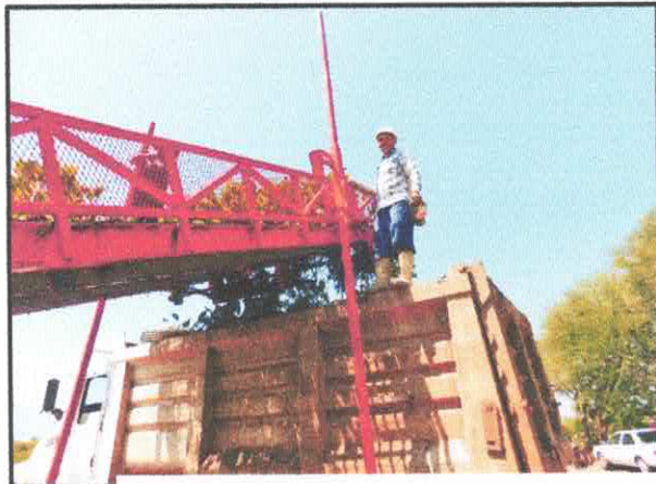
Figura 9. Banda cosechadora de malezas acuáticas depositando el lirio extraído del humedal “Presa La Vega” en el camión tipo volteo propiedad de la JIMAV.
